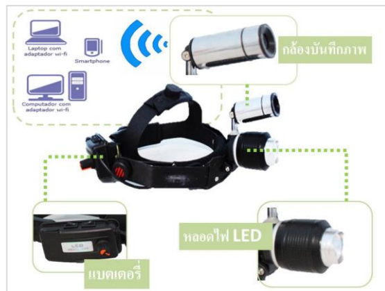
ภาพที่ 4 ผังระบบการทำงานของเครื่อง Headlight
